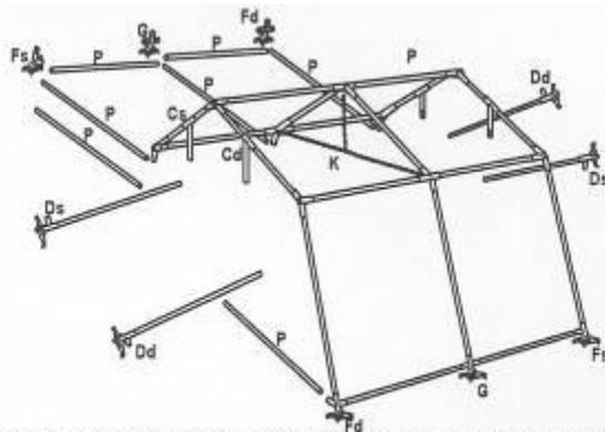
I Comporre tutta l'armatura del tetto e le gambe di un lato, complete degli elementi a terra. Agganciare la catena di tenuta "K". Se prevista, montare la camera interna in questa fase distendendola nello spazio sottostante la paleria e agganciandola alla linea di colmo seguendo le istruzioni presenti nella camera.
