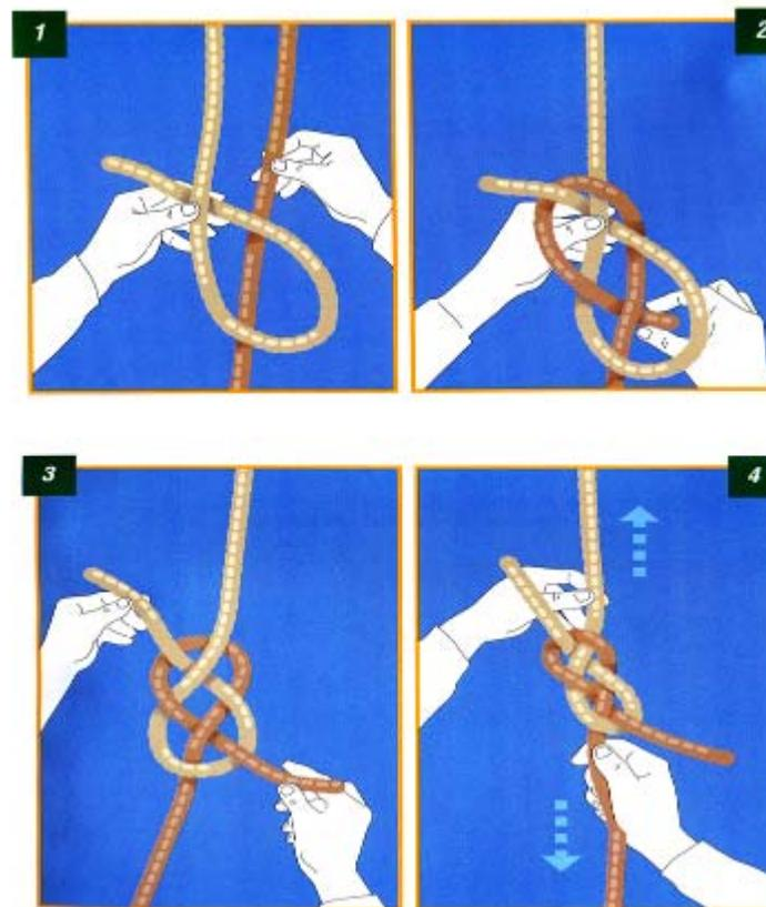
**Nodo di avvolgimento, per cavi di modesta sezione è bene aumentare il numero delle volte sull'anello.**
